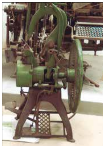
12. Zszywarka do szycia drutem – stan przed remontem – fot. J. Czopowicz 2008
